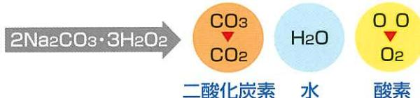
二酸化炭素・水・酸素に分解することにより活性酸素を発生させます。酸素発生により被洗物と有機物(汚れ・油分など)のすきまにEco21-Kが入り込み汚れの剥離をより円滑に進行させます。また同時に生分解を促進させ排水時には、自然界のバクテリアの働きにより2~3週間で河川水中内で自然界分解させるメカニズムを有します。
